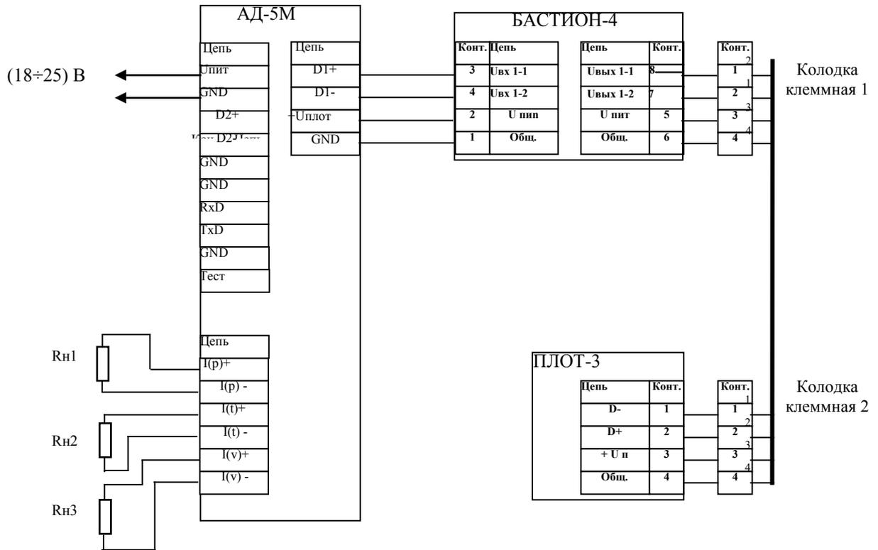
R<sub>н1</sub>, R<sub>н2</sub>, R<sub>н3</sub> – сопротивления нагрузки (до 800 Ом) токовых сигналов по плотности, температуре и вязкости, соответственно.
