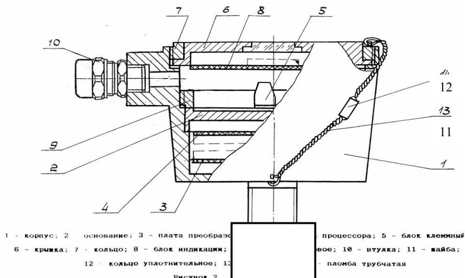
1 – корпус; 2 – основание; 3 – плата преобразователя; 4 – плата процессора; 5 – блок клеммный; 6 - крышка; 7 – кольцо; 8- блок индикации; 9 – кольцо резьбовое; 10 – кабельный ввод; 11 – проволока; 12 – пломба трубчатая.
